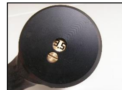
Bild 6: Einstellung des Hubes (Serien SK 14 und SK 15)
