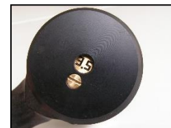
Bild 6: Einstellung des Hubes (SK 14, SK 14 short und SK 15)
