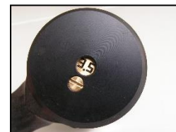
Bild 6: Einstellung des Hubes (Serien SK 14 und SK 15)
