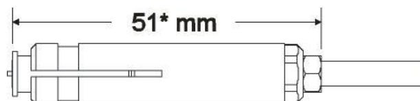
Bild 2: Einstellung des Bolzenhalters bei Pistole ESP 1 S für Bolzen bis 40 mm Länge * 67 mm bei Bolzen über 40 mm Länge * 57 mm bei Bolzen M 10
