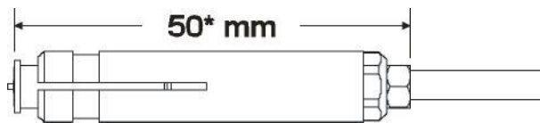
Bild 4: Einstellung des Bolzenhalters bei Pistole ESP 1 K für Bolzen bis 40 mm Länge * 66 mm bei Bolzen über 40 mm Länge * 57 mm bei Bolzen M 10
