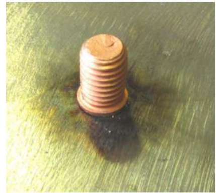
Bild 9: Schweißung mit zu geringer Energie, kein sichtbarer Spritzerkranz
