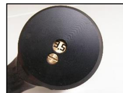
Bild 5: Einstellung des Hubes (SK 14, SK 14 short und SK 15)
