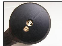
Bild 6: Einstellung des Hubes (Reihe SK 14 und SK 15)
