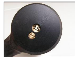
Bild 6: Einstellung des Hubes (Reihe SK 14 und SK 15)
